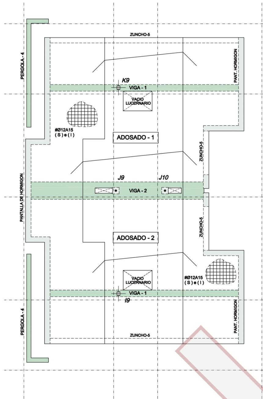
**PLANTA CUBIERTA INCLINADA - ARMADO (ADOSADOS 1 Y 2)**
